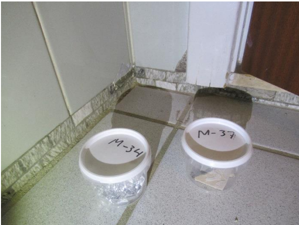
Eksempel på udtagende prøver indeholdende asbest og bly/nikkel i kategorierne farligt og forurenet affald (M-34 og M-37).
